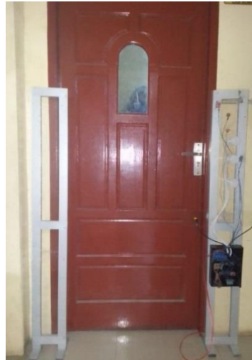
Gambar 2. Tampilan Depan Sistem Monitoring Jumlah Pengunjung Tingkat Kebisingan Dan Kendali Intensitas Cahaya Perpustakaan Terintegrasi Internet Of Things
